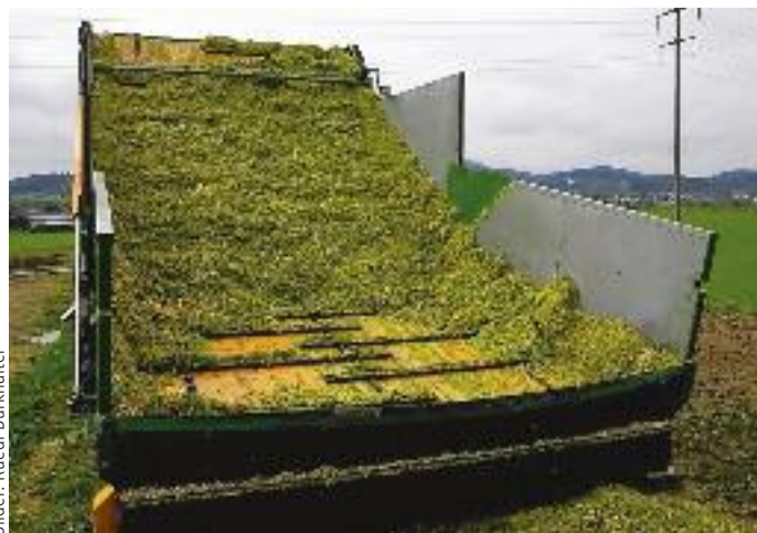
Die zunehmende Steigung des Bunkerkratzbodens wirkt als einfache Dosiereinrichtung. Walzen oder Ähnliches sind nicht erforderlich.
