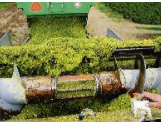
Vom Ausgang des Bunkers wird das Erntegut mit Schnecken in den Fallschacht gefördert.
