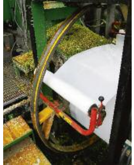
Die erste Wickelfolie wird auf den Presskanal gelegt und von der Pressbewegung abgezogen.
