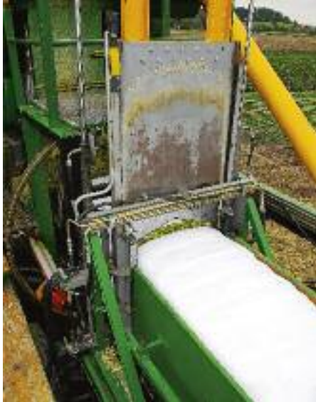
Ein hydraulisch betätigtes Messer schneidet die Endloswurst zu Ballen mit variabler Länge.
